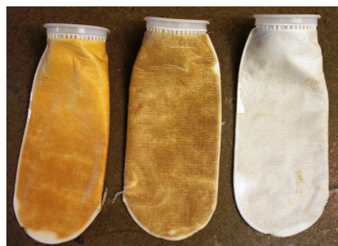
Bilden visar filternas försmutsningsgrad där starten är från vänster och slutresultatet längst till höger.
