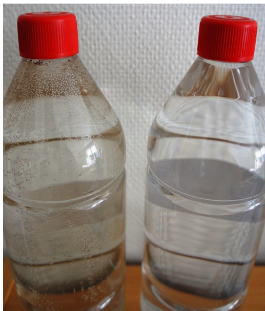
Provet innan start (till vänster) uppvisar kraftig fouling på provflaskans insida. Slutprovet (till höger) är en klar och ren systemvätska.
