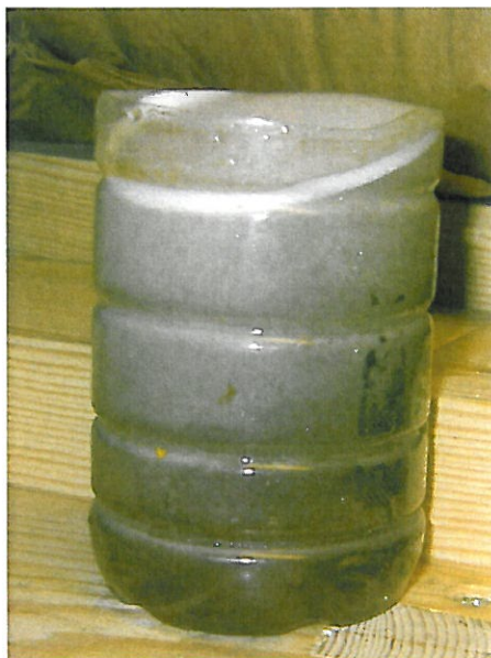
Vandprøve fra et varmeanlæg inden lynafgasning, mælkehvidt af mikroobler
