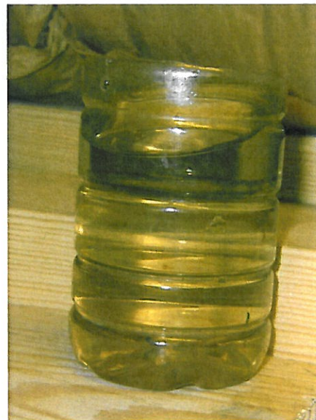
Vandprøve fra samme varmeanlæg – efter 6 timers lynafgasning
